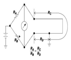
FIGURE .1. MURRAY LOOP TEST
