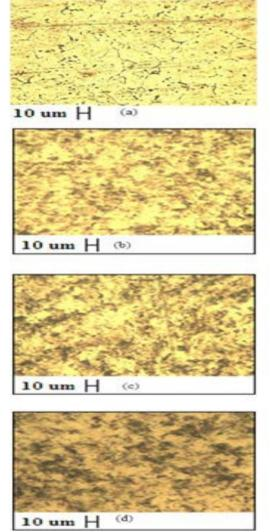
Figure 3: Optical Microstructures of (a) Al 7075 (b) 95 vol % Al-7075 + 5 vol % Red Mud (c) 90 vol % Al-7075 + 10 vol % Red Mud (d) 85 vol % Al-7075 + 15 vol % Red Mud
